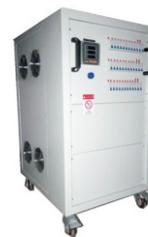
RCD 负载是一种非线性模拟负载，用于测试UPS电源、逆变电源和光伏模拟器等电子产品。通过模拟计算机、网络通讯设备等非线性负责特性，达到对电源输出功率和质量的精准控制，避免被测产品在实际使用时无法带动负载或对电网造成污染，有效的检测电源产品的带载特性。广泛用于电力、船舶、广电、电信等部门以及UPS、逆变器、开关电源、等生产厂家的交流电器产品带非线性负载类的性能检测和老化测试。拓沃得RCD负载箱，电阻负载选用新型功耗组件，电阻热缩并密封安装在不锈钢管内，钢管外部带绝缘散热片，防潮防腐性好，绝缘性高，安全可靠。电阻元件功率密度高，无红热现象，有独立的冷却风机，保证了整个产品的散热性和寿命。容性负载选用原装进口组件，工作时间长达6000小时以上。RCD负载箱可根据客户实际需要，提供定制开发产品服务。
