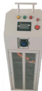
交流充电桩简易测试系统-TCA1000，专用于模拟充电过程和各种故障的测试系统。内部集成控制引导线路模块，交流电压采样模块，交流电流采样模块，充电异常模拟模块，时序量测模块，通讯控制模块，触屏显示模块等。本系列应用于交流充电桩产品的在线调试、生产线检测等，有效摆脱实车作为检测装置的测试局限。
